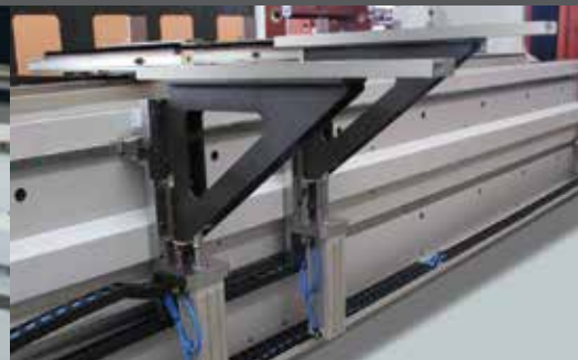
Op maat gemaakte voorste oplegarmen met CNC-hoogteregeling
