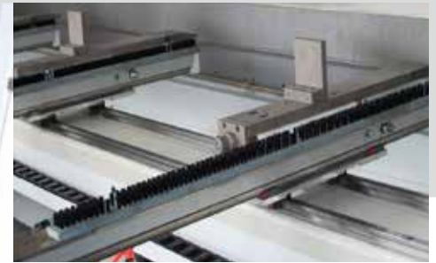
Achteraanslag met pneumatische borstelsteun voor dunne plaat
